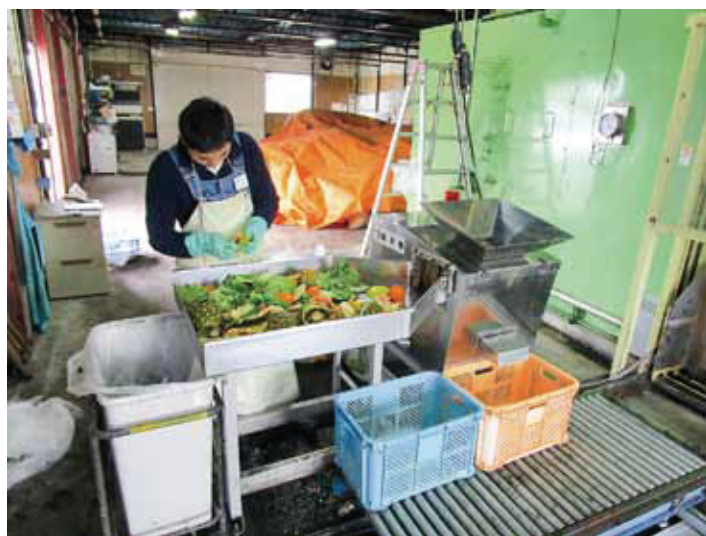
回収した食品残渣から肥料化できないシールを分別
